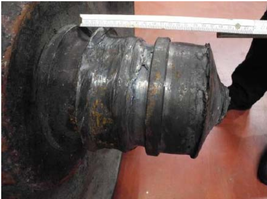
Abb. 9: Schadseite des Radsatzes 86 646
