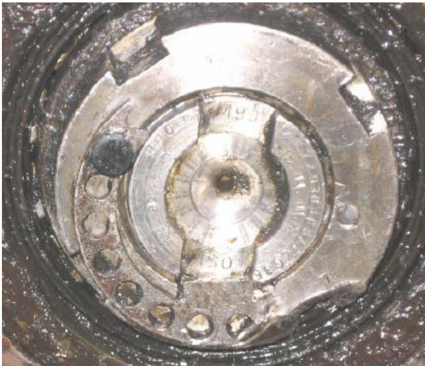
Abb. 10: Nutmutter der Gegenseite mit ab gescherter Sicherungsschraube
